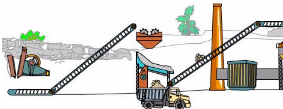
(b) Seleção granulométrica do calcário por peneiramento.
