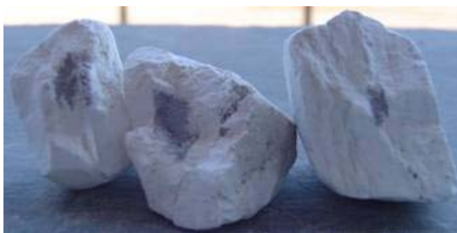
Figura 2.9 – Pedra de cal virgem com núcleo de carbonato não dissociado.
