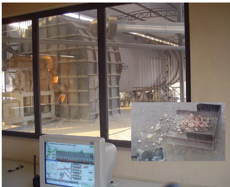
Figura 2.13 – Controle de qualidade do processo produtivo de cal na Indústria de Cal Cruzeiro: Controle automático e visual baseado na experiência do operador.
