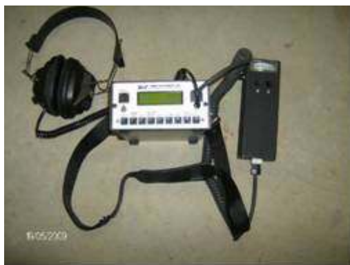
Figura 7.5 – Aparelho para ensaio de pacometria.
