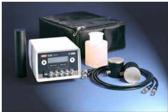
Figura 6.3 – Aparelho de Ultra-sonografia
