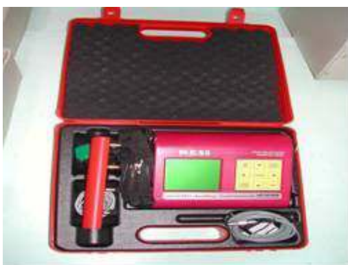
Figura 7.9– Aparelho para medição de Resistividade do concreto.
