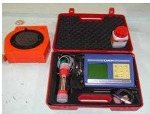
Figura 7.6 – Aparelho para medição de de potencial de corrosão
