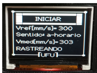
(b) Foto da página de monitoramento de ensaio com o Tracionador em operação.
