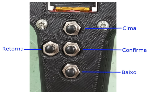
Figura 37 – Foto dos botões do joystick com descrição de suas funcionalidades.
