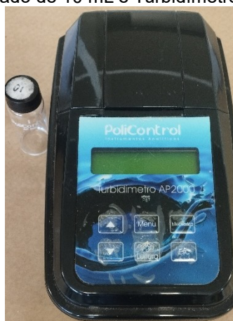
Figura 4 - Frasco graduado de 10 mL e Turbidímetro AP2000 da PoliControl.
