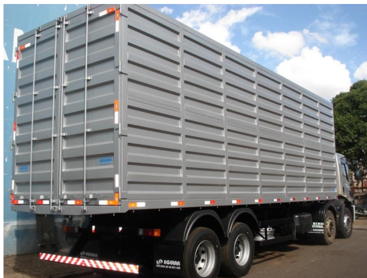
Figura 3.11 - Basculante cavaqueira (Fonte: Aguiar Implementos Rodoviários)
