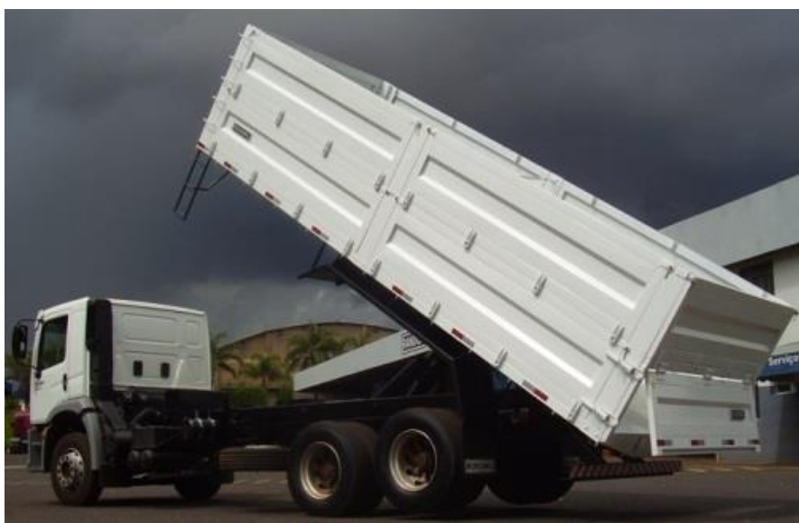
Figura 3.10 - Caçamba Graneleira (Fonte: www.rodofil.com.br acesso em 20/07/2013)
