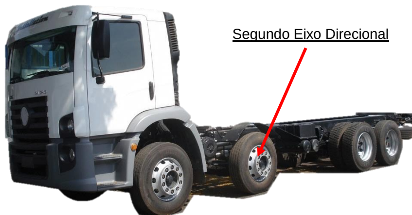
Figura 3.5 – Exemplo de caminhão com quarto eixo direcional instalado (Fonte: Aguiar Implementos Rodoviários)
