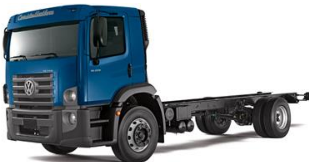
Figura 3.1 – Exemplo de caminhão dois eixos (Fonte: http://www.manla.com/images/stories/produtos/caminhao/ficha_tecnica/pdf/2812/08_Constellation_15_190_fev_2013.pdf )
