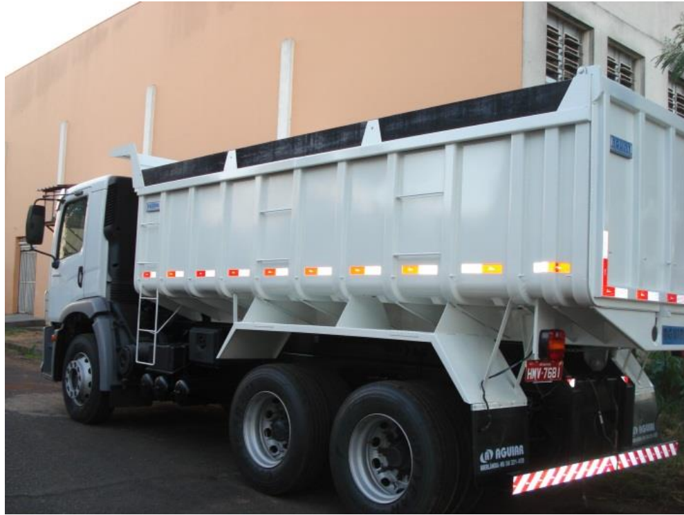
Figura 3.8 - Caçamba modelo areia e brita (Fonte: Aguiar Implementos Rodoviários)
