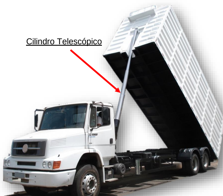
Figura 2.1 - Sistema de acionamento por Cilindro Frontal (Fonte: Aguiar Implementos Rodoviários Ltda.)
