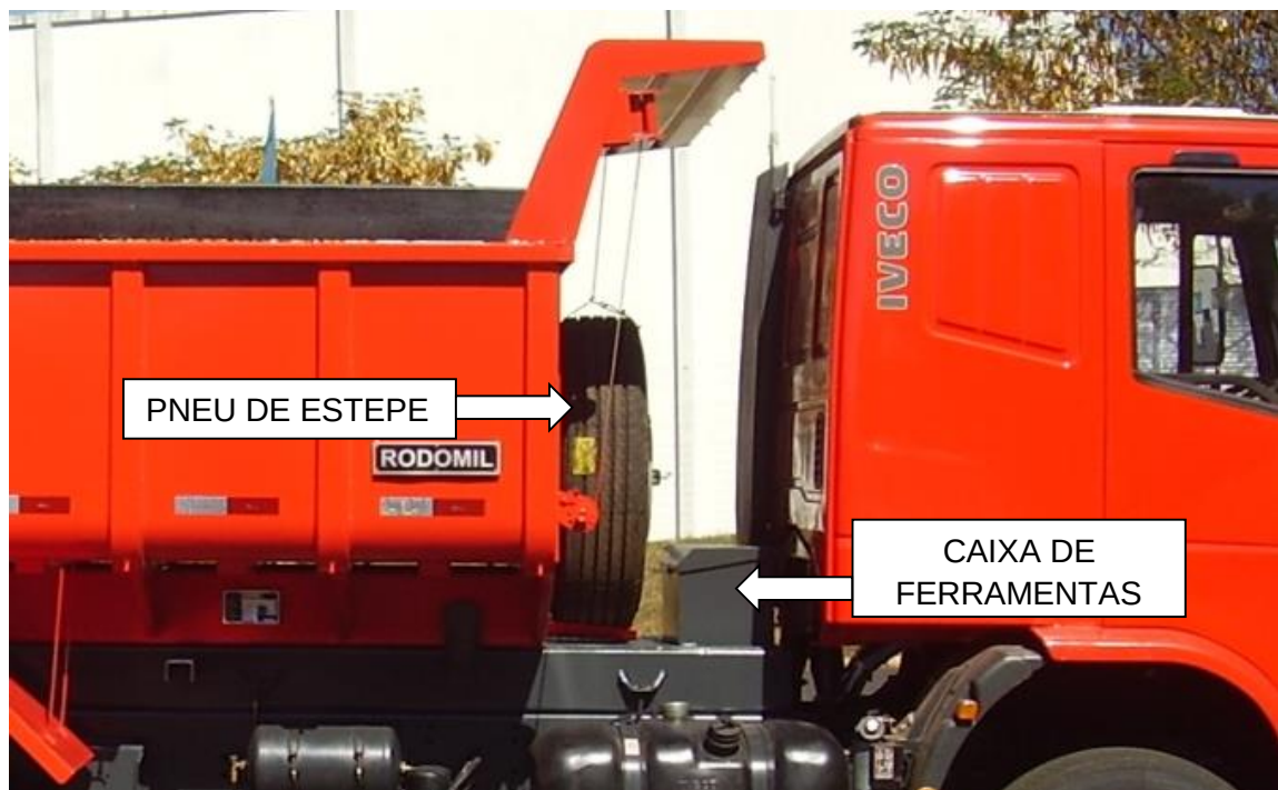
Figura 3.9 - Suporte de estepe frontal e caixa de ferramentas (Fonte: Mil Implementos Rodoviários Ltda)
