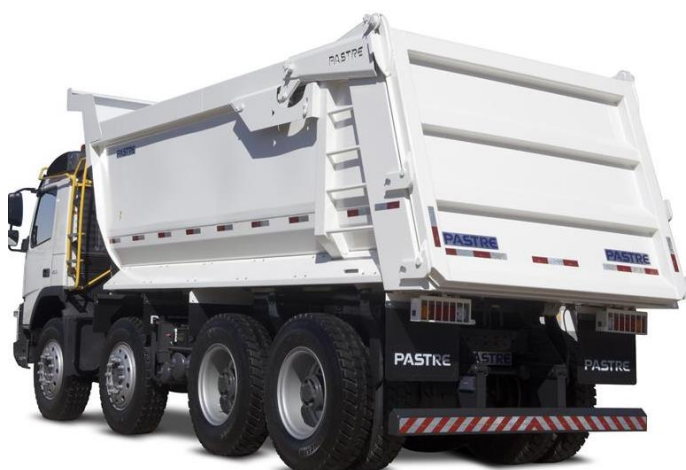
Figura 2.3 - Caçamba meia cana acionada por cilindro frontal (Fonte: www.pastre.com.br )
