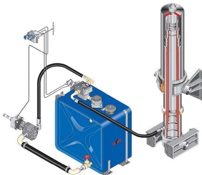
Figura 2.2 - Cilindro Telescópico com sistema hidráulico (Fonte: www.hyva.com/br )
