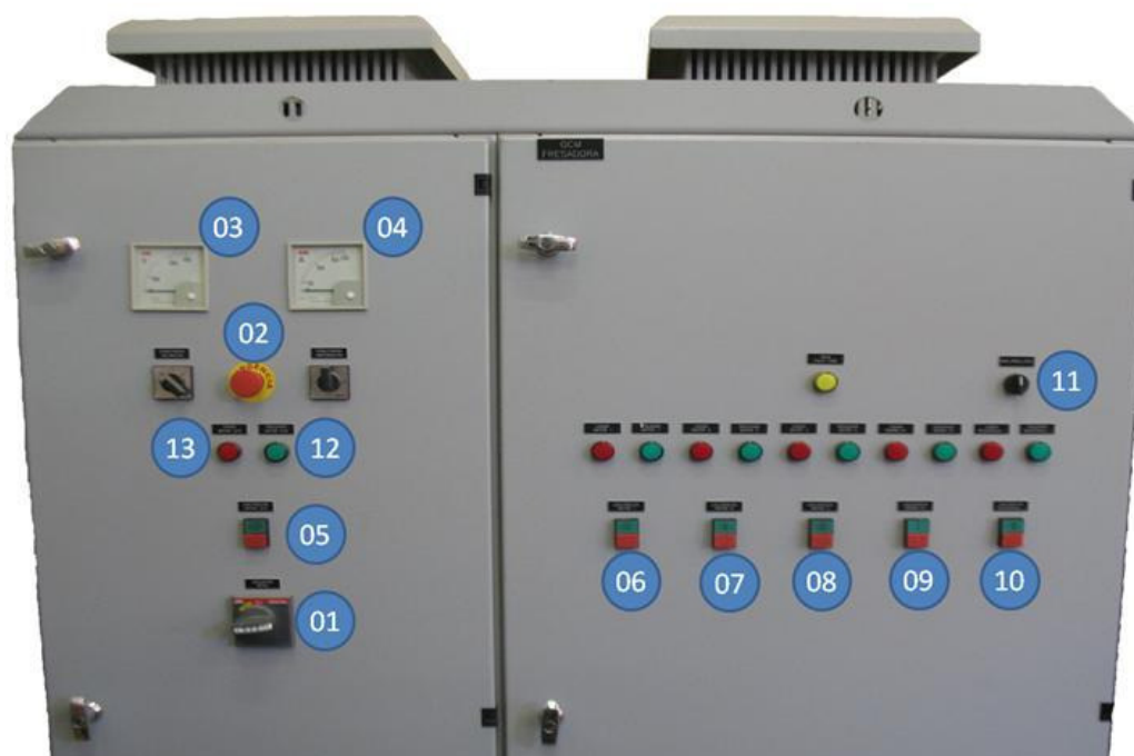
Figura A. 3 - QCM da Fresadora: 01 – Chave de acionamento do QCM da fresadora; 02 – botão de parada de emergência; 03 – mostrador analógico de tensão; 04 – mostrador analógico de corrente; 05 – botões para acionar e desligar o motor responsável pela rotação; 06 – botões para acionar e desligar o motor responsável movimentação do eixo x; 07 – botões para acionar e desligar o motor responsável movimentação do eixo y; 08 – botões para acionar e desligar o motor responsável movimentação do eixo z; 09 – botões para acionar e desligar o motor responsável pela bomba; 10 – botões para acionar e desligar a resistência elétrica; 11 – chave de seleção do automático / desligado / manual da resistência elétrica; 12 – mostrador da chave respectiva desligada; 13 – mostrador da chave respectiva ligada.
