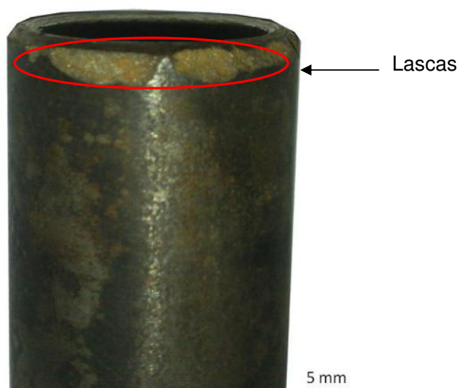
Figura 4. 51 – Corpo de prova ao término do primeiro ensaio com depósito brasado de granulometria fina com rotação de 75 rpm
