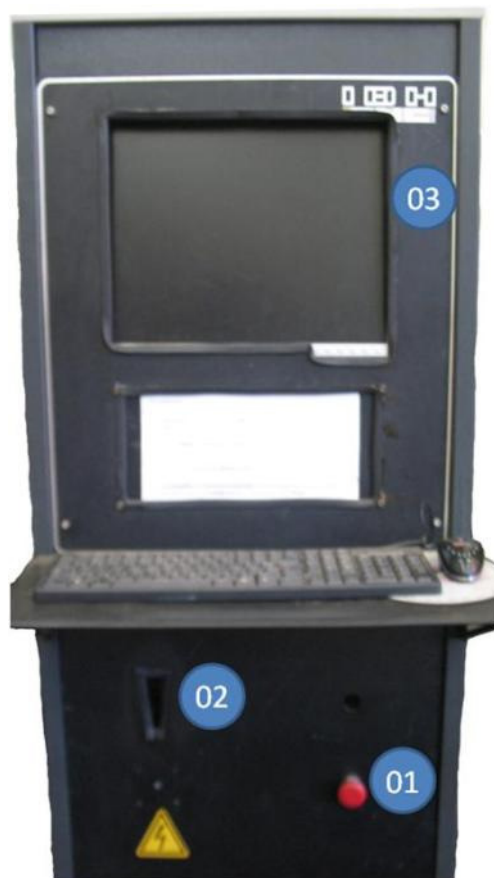
Figura A. 4 - Central de controle e aquisição: 01 – Botão de parada de emergência; 02 – botão de acionamento da central; 03 – tela de visualização da interface gráfica.~
