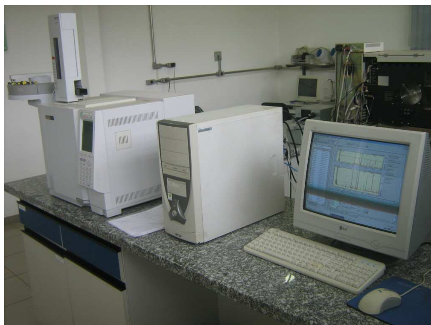
FIGURA 5. Cromatógrafo Gasoso (CG-FID) utilizado para quantificação dos constituintes do óleo essencial.
