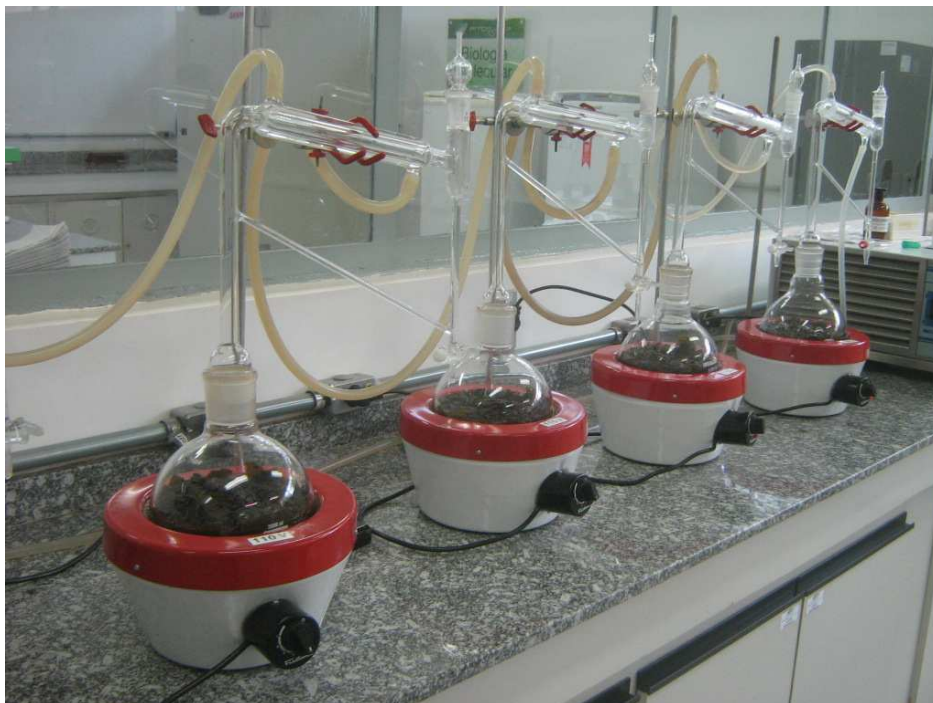
FIGURA 4. Extração de óleo essencial por hidrodestilação em aparelho tipo Clevenger.
