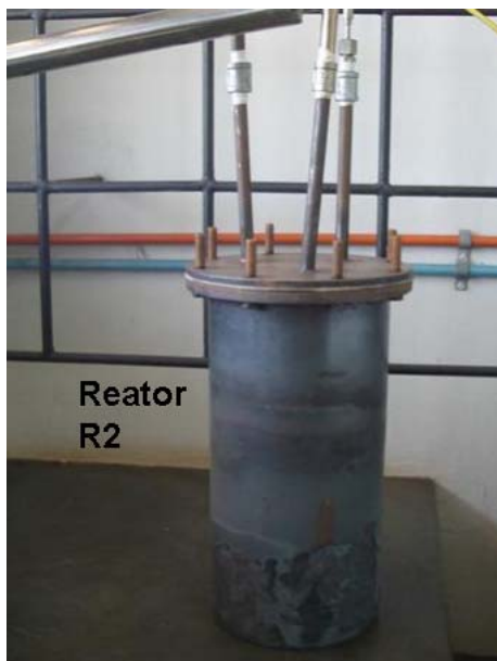
Figura 4.4 – Foto do reator R2 construído de aço-carbono.
