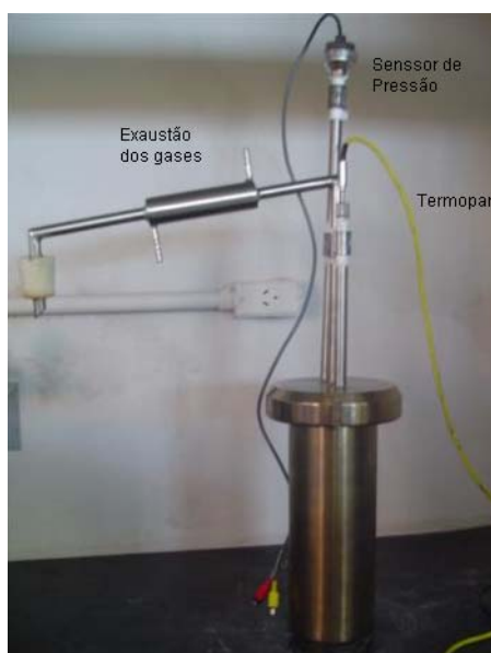
Figura 4.3 – Foto do reator R1 construído de aço-inox
