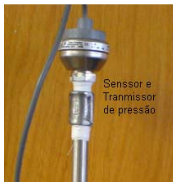
Figura 4.6 – Foto do sensor e transmissor de pressão (Cole Parmer – 68075-32).
