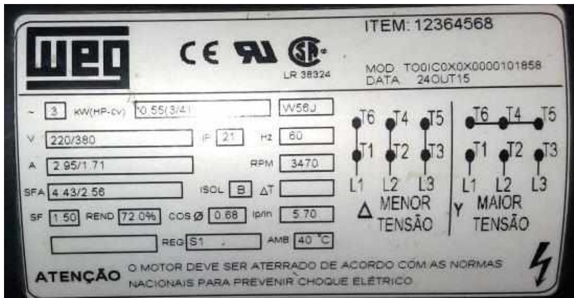
Figura 4.4c - Placa do motor elétrico da Bomba BC-92 T1 3/4.
