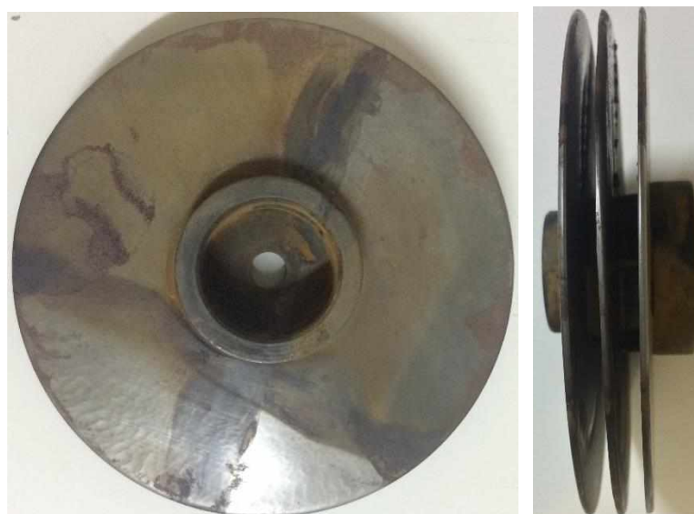
Figura 4.16 – Rotor de discos desgastado após o teste.
