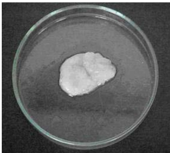
Figura 3.4 – Formato apresentado pela goma momentos após sua precipitação.
