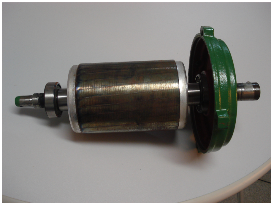
Figura 3.8 – Vista lateral do rotor com uma das tampas anexada em seu eixo.
