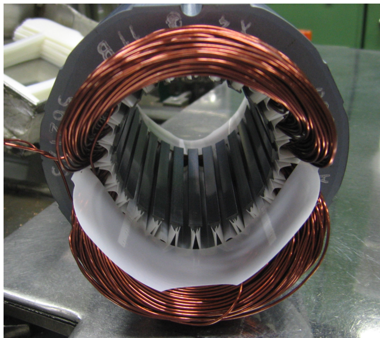
Figura 3.19 – Filme isolante sendo inserido para isolamento entre fases, com passo do enrolamento e região da cabeça da bobina.
