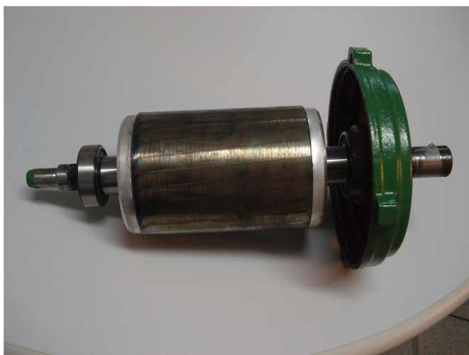
Figura 2.10 – Vista lateral do rotor com uma das tampas anexada em seu eixo.
