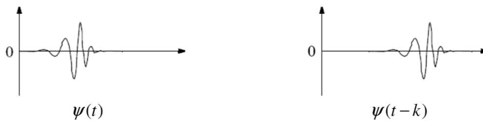
Figura A. 6. Exemplo de deslocamento de sinal usando Wavelet [71].
