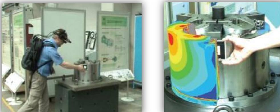
Figura 3.2 - (a) colocando um marcador em um sistema e (b) visualizando a malha de elementos finitos para o estudo particular de análises de temperatura (Weidlich. et. al. 2008).
