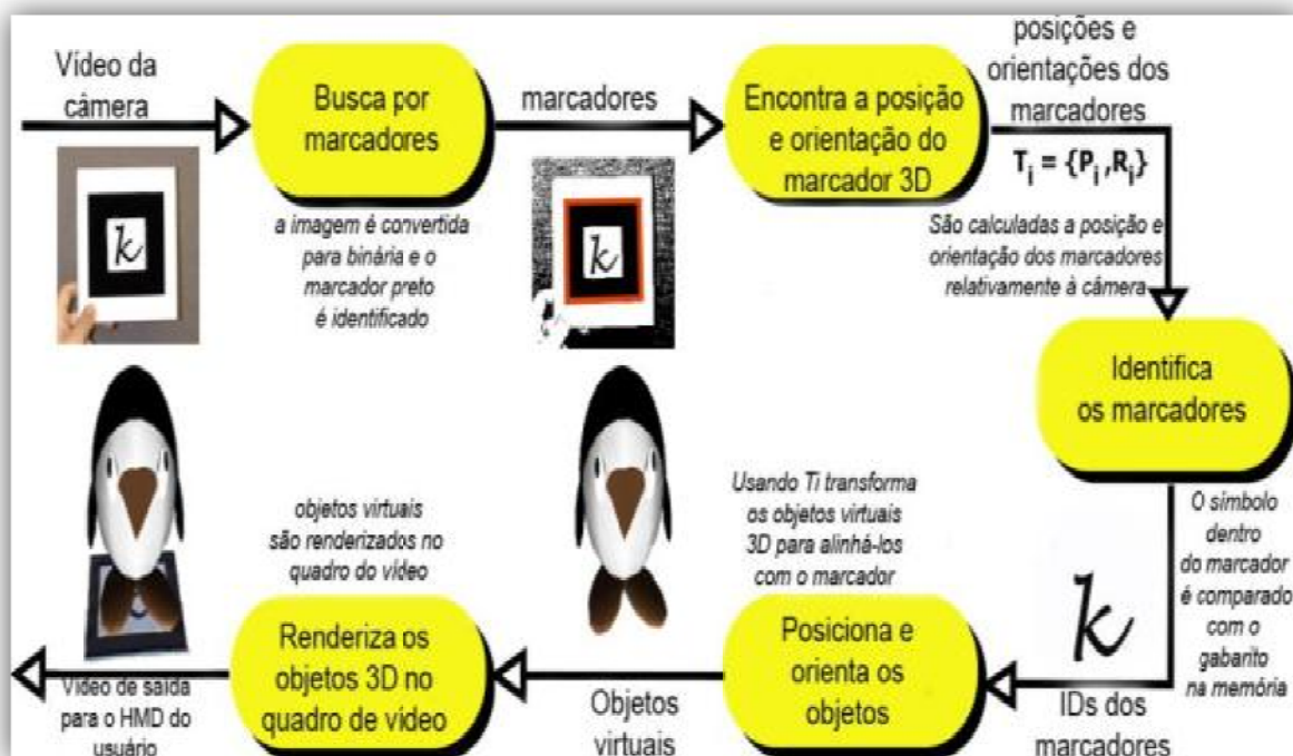
Figura 3.6 - Diagrama de funcionamento do ARToolkit adaptada de (Kato, 2000)
