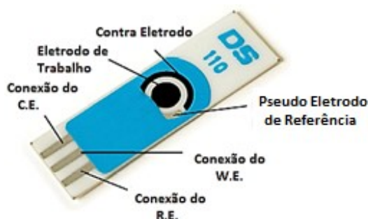
Figura 6 – Esquema ilustrativo de um eletrodo impresso de carbono típico com os três eletrodos: Trabalho (W.E.), Pseudo referência (R.E.) e Contra eletrodo (C.E.)
