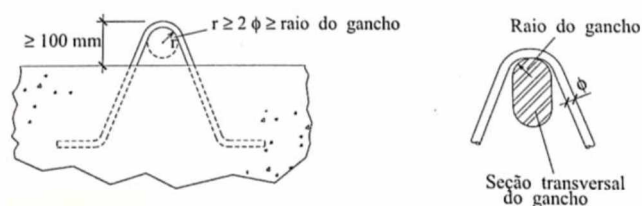
Figura 23 – Indicações para detalhamento das alças de içamento
