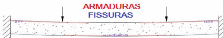
Figura 16 – Detalhe longitudinal de viga biengastada com fissuras
