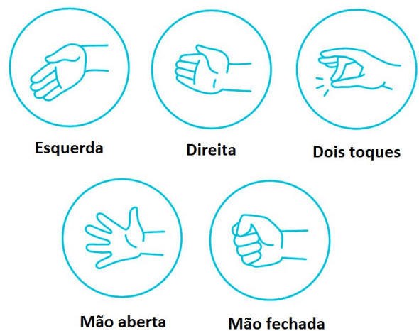
Figura 6 – Movimentos adotados para o controle do veículo utilizando o bracelete Myo.
