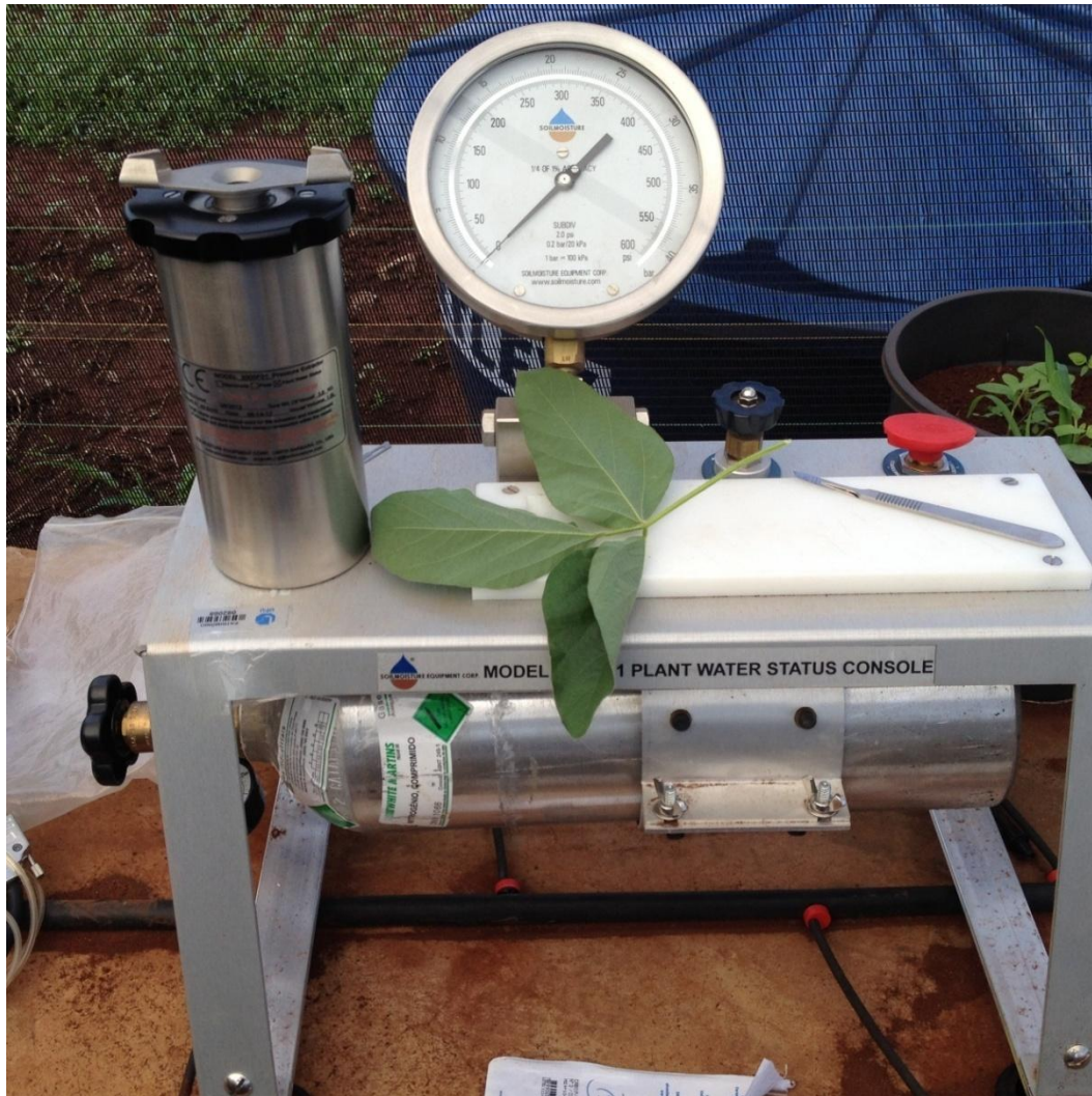
Figura 8. Câmara de pressão, usada para a medição do potencial hídrico do xilema (SCHOLANDER et al., 1964).
