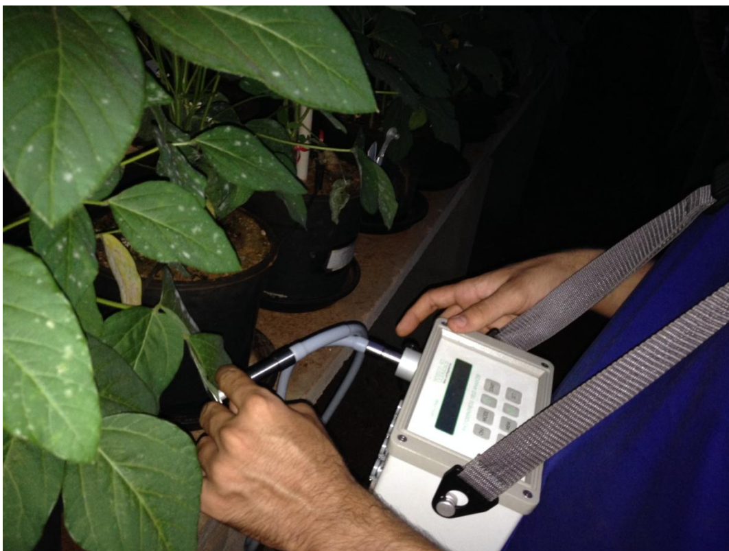
Figura 9. Análise de fluorescência adaptado ao escuro com a utilização do medidor de ganho fotossintético de amplitude modulada de pulso (Mini-PAM) e presilhas.
