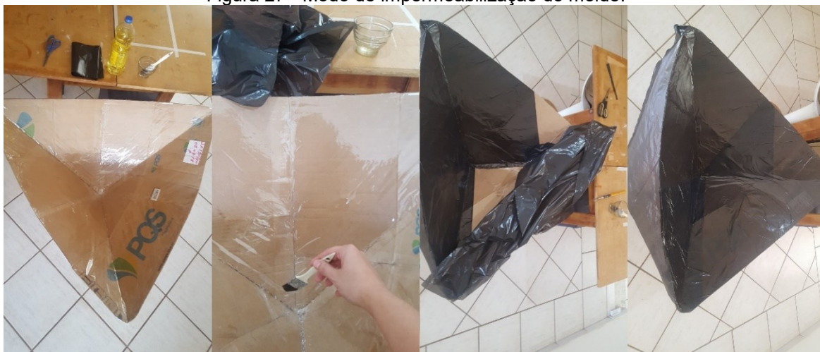
Figura 27 - Modo de impermeabilização do molde.
