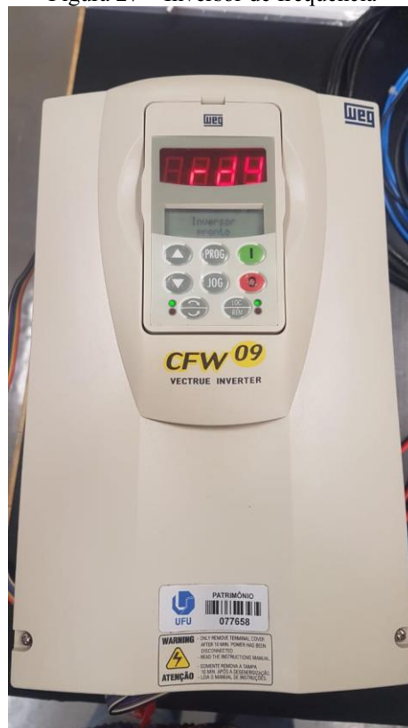
Figura 27 – Inversor de frequência
