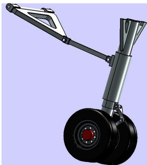
Figura 3.17-Modelo final do trem de pouso de nariz
