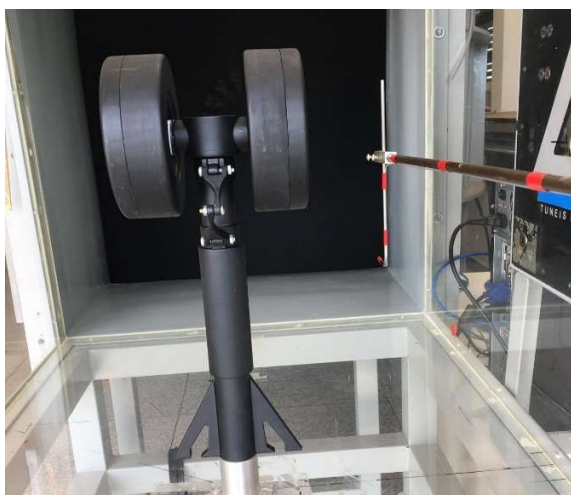
Figura 3.28- Trem de pouso dentro da seção de teste do túnel do vento (autoria própria)
