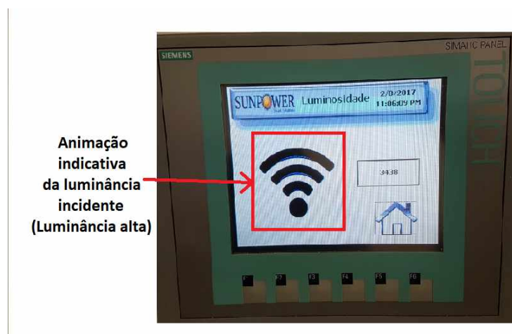
Figura 44 – Tela de monitoração da luminância incidente no painel fotovoltaico - iluminação Alta
