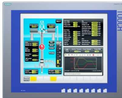
Figura 4 – IHM Siemens como Sistema Supervisório
