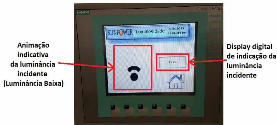
Figura 43 – Tela de monitoração da luminância incidente no painel fotovoltaico - iluminação baixa
