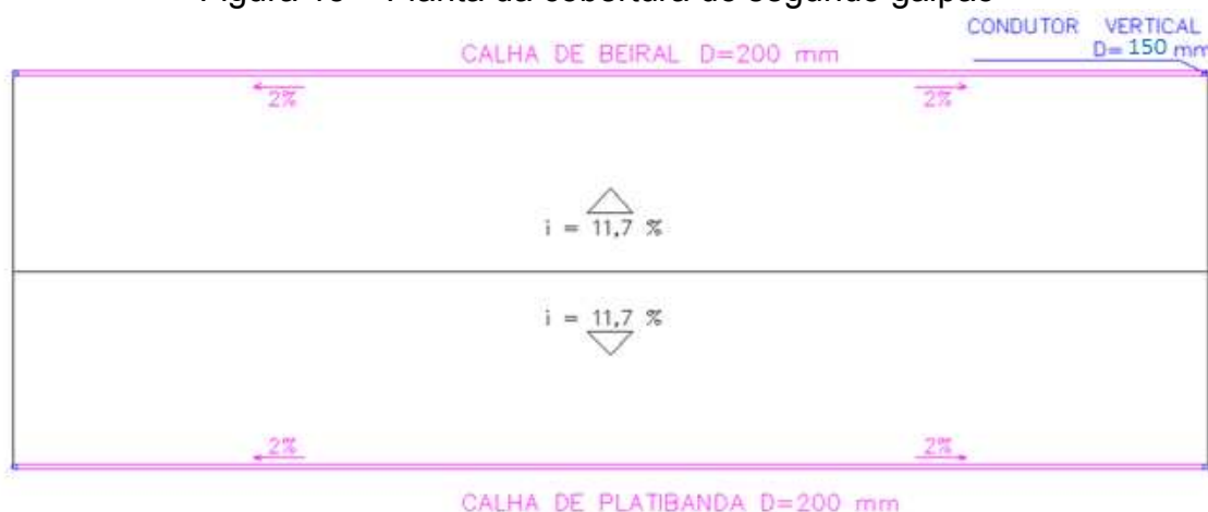
Figura 15 – Planta da cobertura do segundo galpão
