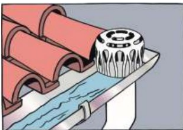
Figura 18 – Bocais para evitar entupimento
