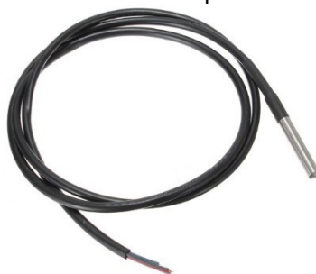
Figura 13. Sensor de temperatura DS18B20
