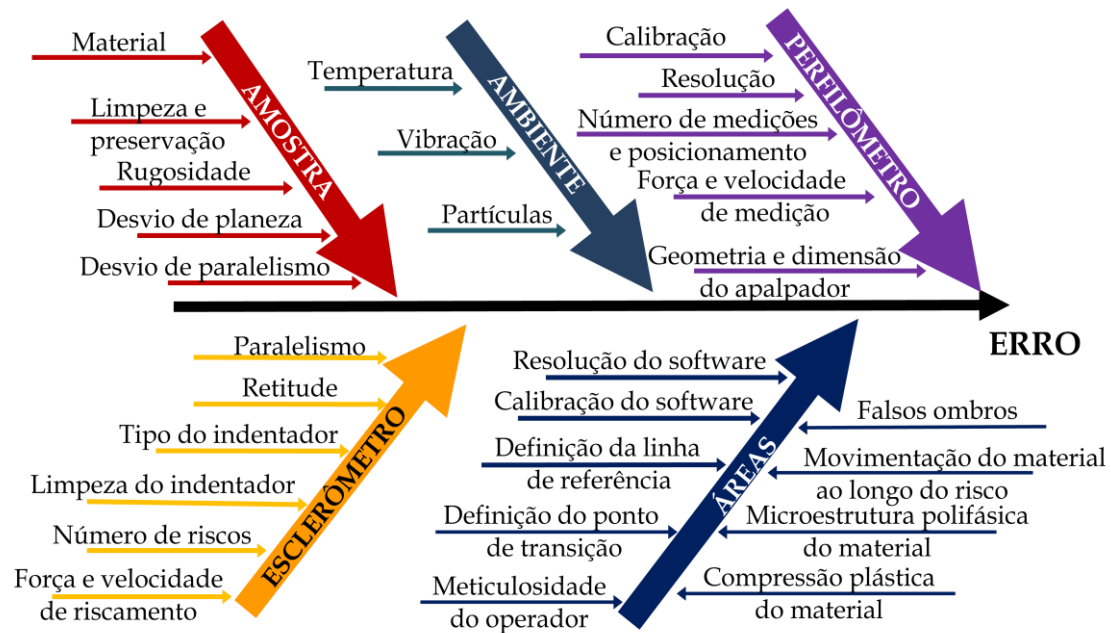
Figura 4.1 – Diagrama de causa e efeito, com as principais fontes de erros observadas na determinação do fator f_{ab} utilizando perfilômetro mecânico (medição com contato).
