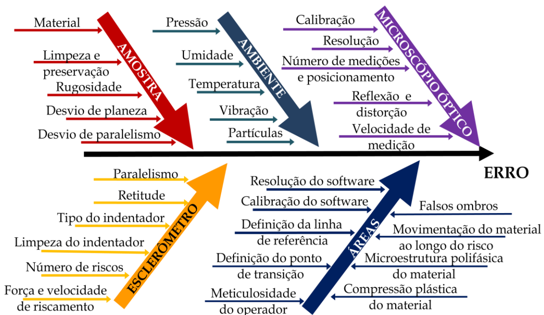
Figura 4.2 – Diagrama de causa e efeito, com as principais fontes de erros observadas na determinação do fator f_{ab} utilizando o microscópio óptico.
