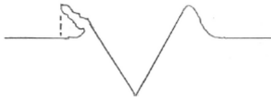
Figura 2.6 – Perfil de um risco com a formação de cavaco à esquerda (FRANCO; SINATORA, 2017).
