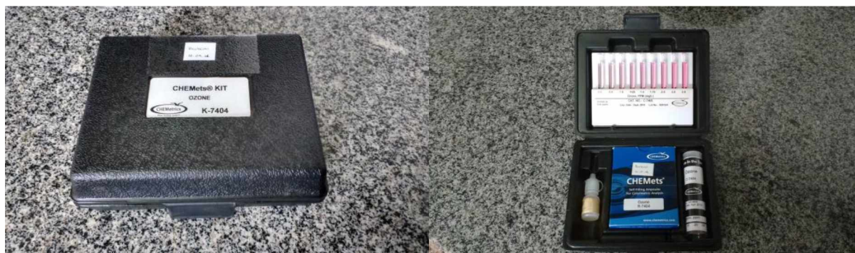
Figura 2. Kit medidor da concentração de ozônio. Fonte: ARAÚJO, 2016.
