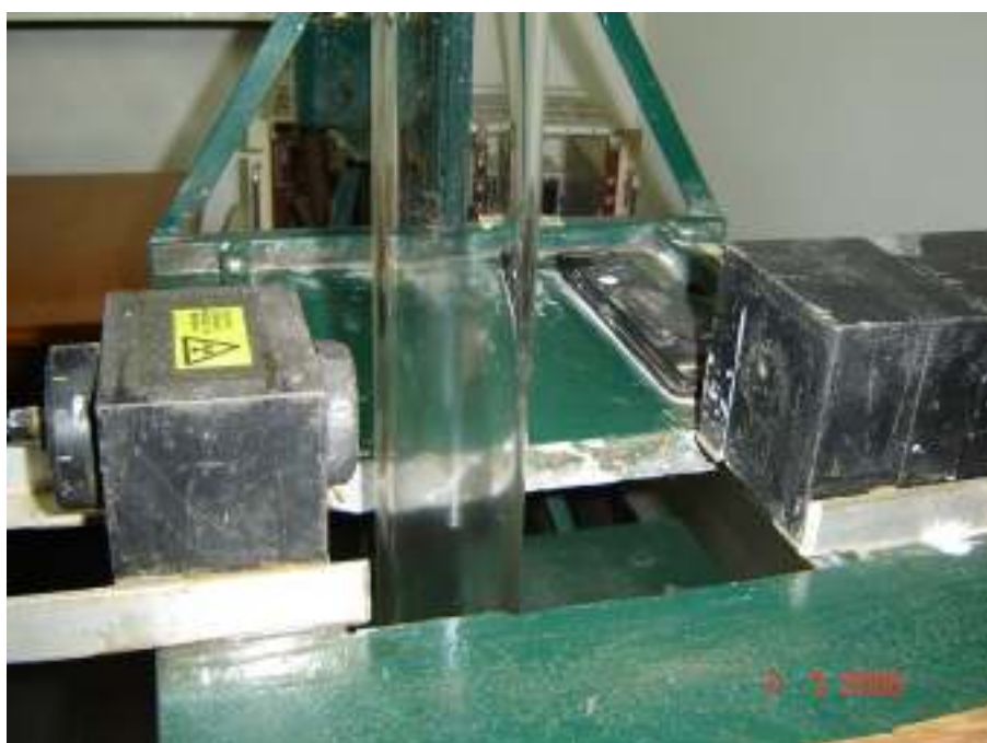
Figura 4.2: Coluna de sedimentação e sistema fonte-detecção de radiação.
