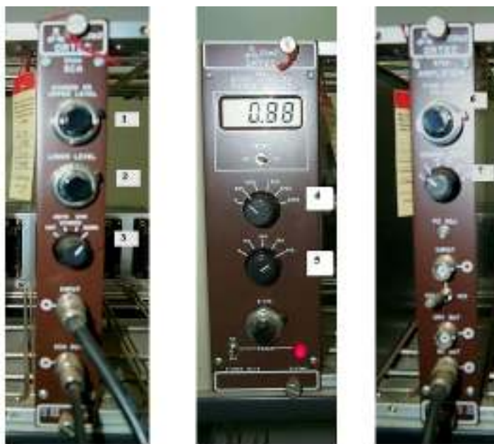
Figura 4.6: Detalhes do SCA e do discriminador de voltagem da fonte de alta tensão e do amplificador.
