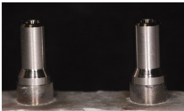
Figura 5. Infraestrutura antes da solda, composta por dois cilindros parafusados no modelo de trabalho. Exemplo do grupo controle (GC).
