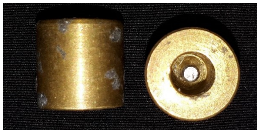
Figura 6. Matriz metálica para padronização da espessura da parede dos cilindros.
