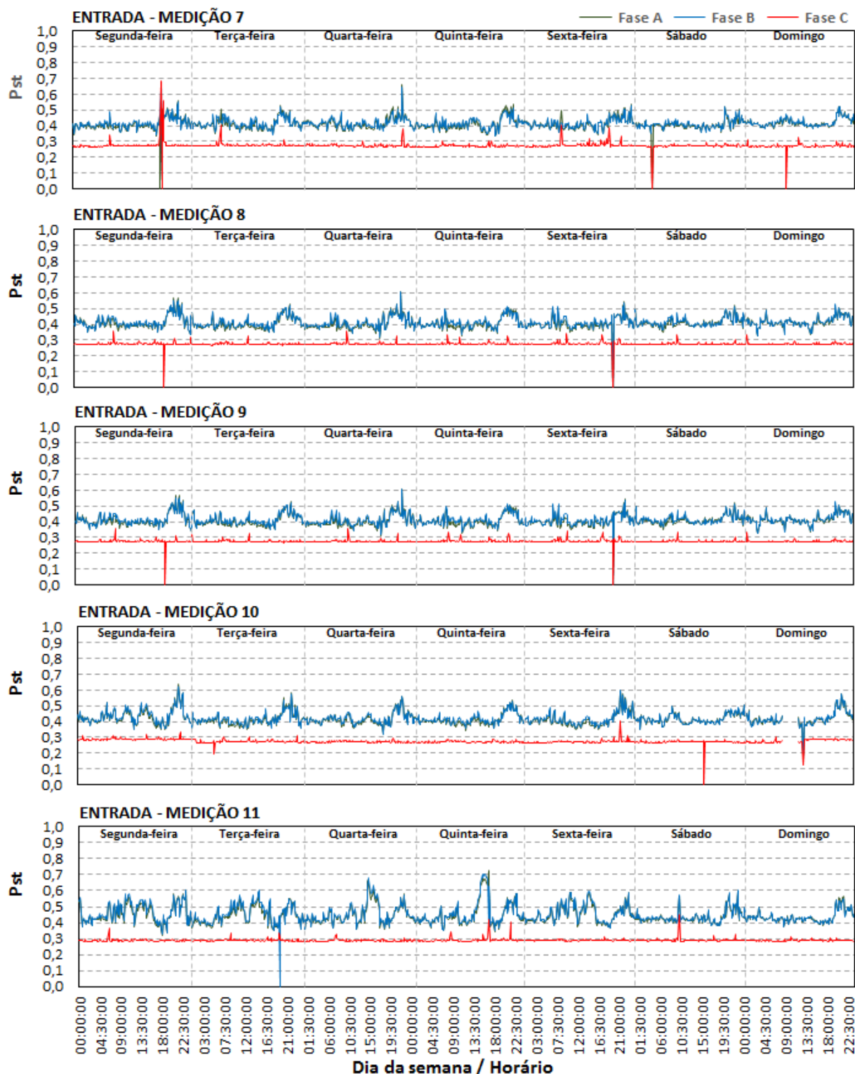
Figura 4.34 – Comportamento semanal da severidade de flicker de curta duração no ponto de entrada para as medições de 7 a 11.
