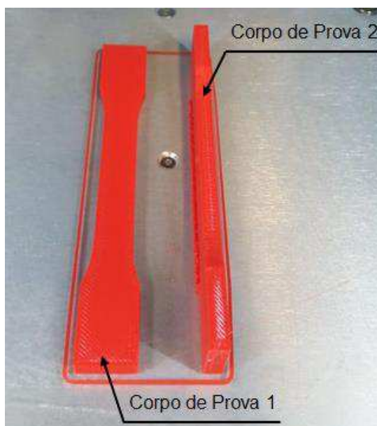
Figura 3.18 - Orientação de impressão dos corpos de prova.
