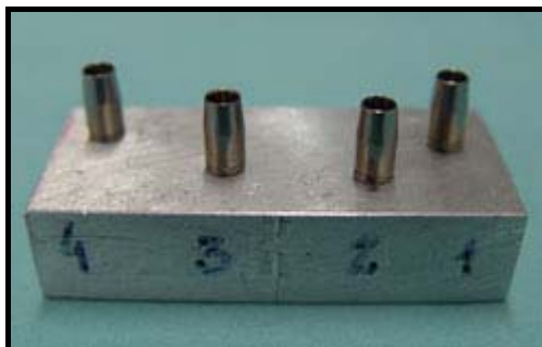
Figura 8 – Pilares Laser instalados com leve aperto manual para leitura em MEV
