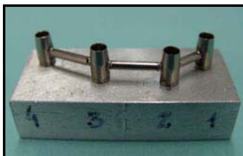
Figura 7 – Uma das infra-estruturas já confeccionada e instalada sobre o modelo de mestre.
