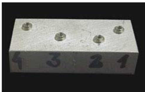
Figura 1 - Modelo mestre em alumínio
