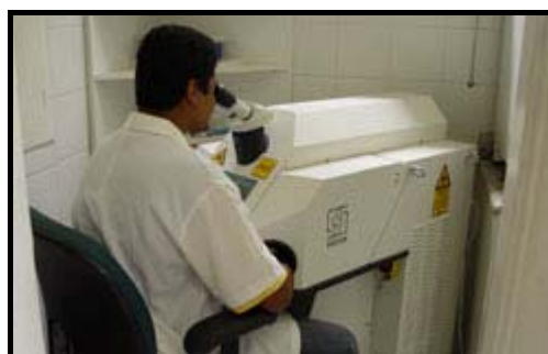
Figura 13 – Aparelho de soldagem a laser
