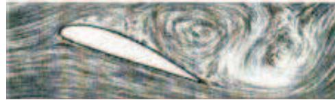
(b) Fluxo de ar separado em volta do perfil da pá (perda aerodinâmica).
