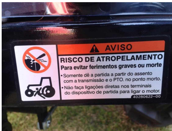
Figura 14. Simbologia de advertência presente nas máquinas agrícolas e implementos.
