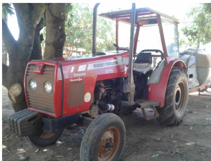
Figura 8. Trator Massey Ferguson 275 equipado com arco de proteção durante capotamento e capota semiaberta.
