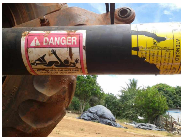
Figura 6. Proteção do eixo cardã com simbologia de perigo devidamente visível e simbologia de atenção rasgada.
