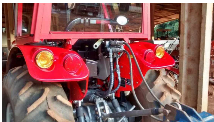
Figura 13. Faróis traseiros e luzes de alerta em um trator agrícola.
