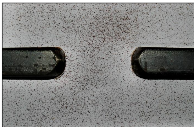
Figura 4.11 - Deposição homogênea de pó de ferro sobre a superfície, utilizando a técnica do chuveiramento
