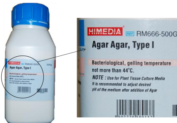
Figura 5.2 - Gelatina Agar Agar, Type I para fixação das limalhas de ferro no espaço volumétrico
