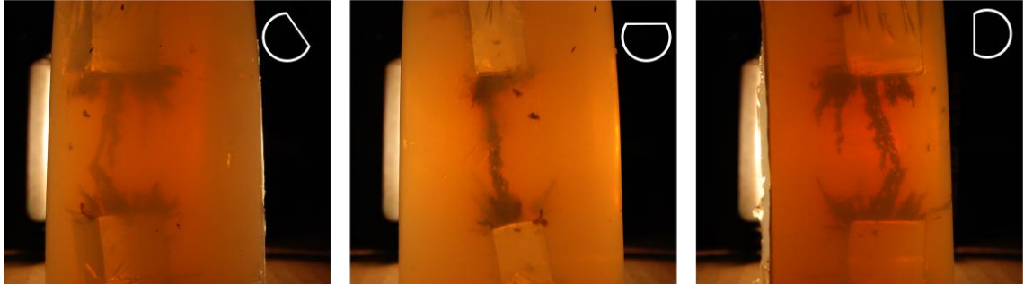
Figura 5.5 - Resultado obtido com a primeira tentativa de visualização 3D, utilizando gelatina a base de Agar Agar e cavacos de aço
