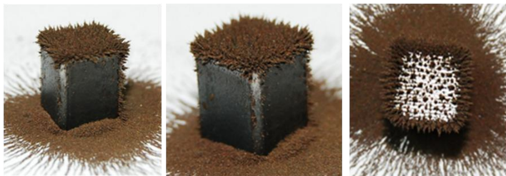
Figura 5.20 - Aplicação da técnica de deposição sobre a face na ponteira Plana
