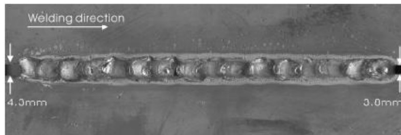
Figura 2.20 - Visualização do cordão no lado oposto da chapa (back bead) (YAMANE et al., 2007)
