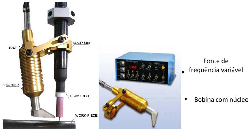
Figura 2.8 - Equipamentos atuais para oscilações de arco de soldagem (HANGIL, 2009)
