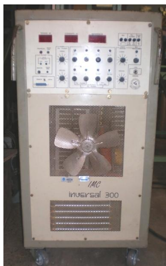
Figura 7.2 - Fonte de soldagem (IMC INVERSAL 300) utilizada para gerar o arco TIG
