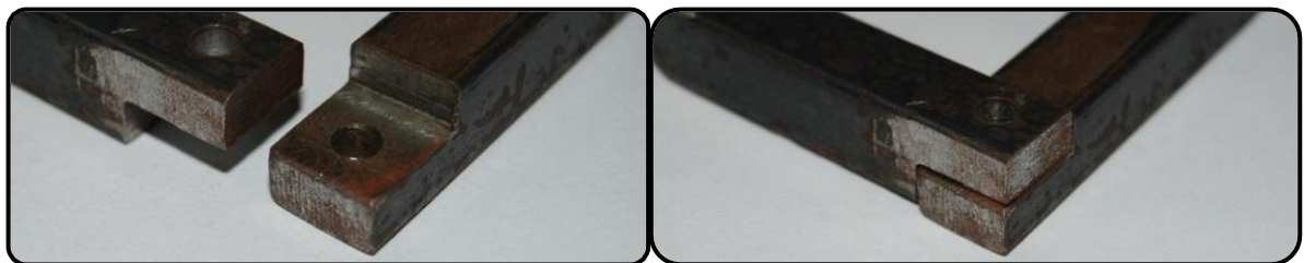
Figura 4.7 - Demonstração da junta de acoplamento entre o núcleo e a ponteira
