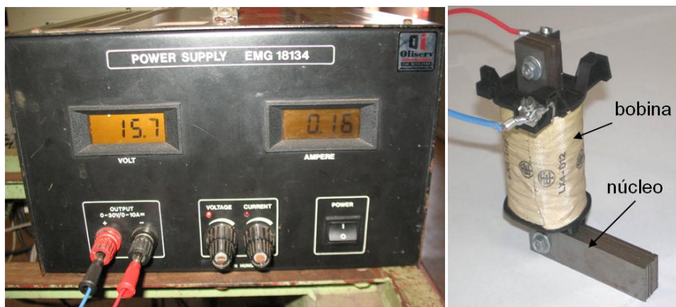
Figura 3.8 - Fonte de alimentação, bobina e núcleo, formando o eletroímã utilizado para geração de linhas de indução
