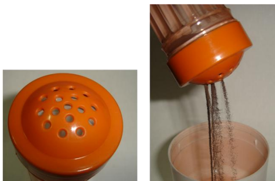
Figura 4.9 - Escoamento contínuo do pó de ferro entre somente alguns furos de um saleiro, dificultando a distribuição homogeneia
