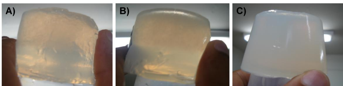
Figura 5.3 - Opacidade e rigidez em diferentes concentrações de Agar Agar em água: em A) com concentração de 0,75 g, em B) concentração de 1,00 g e em C) concentração de 1,25 g.
