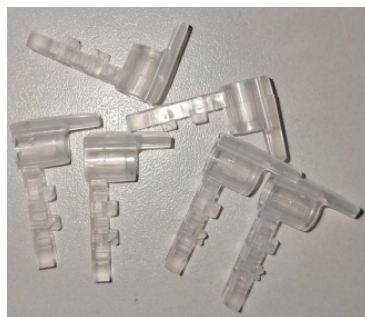
(e) Suporte para os motores elétricos. São utilizados quatro suportes na configuração final.
