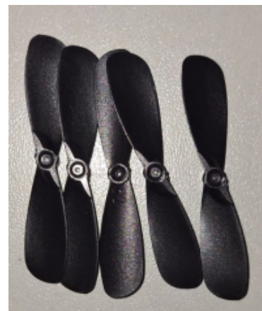
(f) Hélices. São utilizadas quatro hélices na configuração final.
