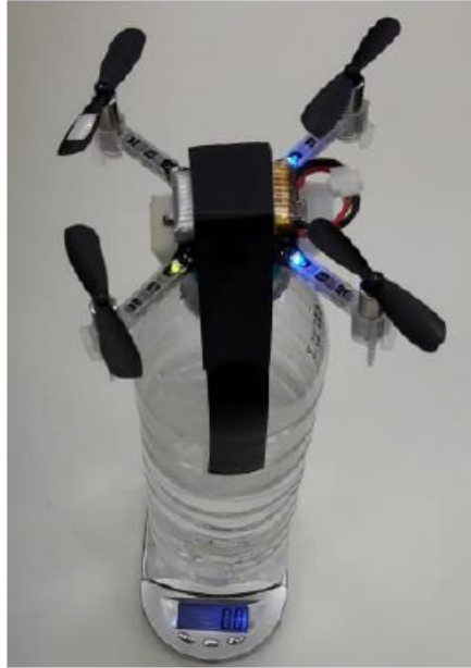
Figura 30 – Experimento para a aquisição do coeficiente de empuxo da aeronave.
