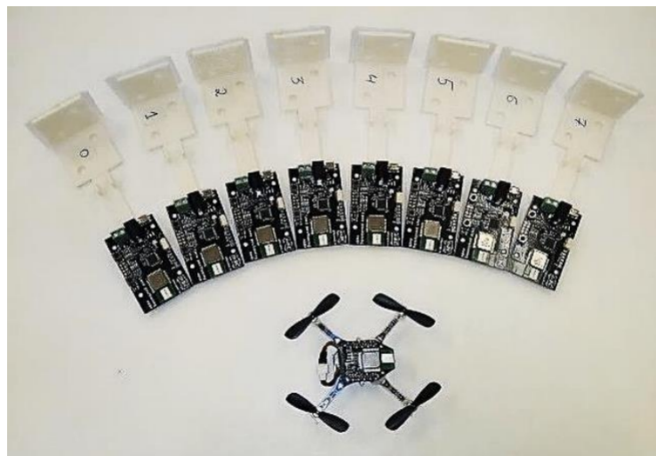
Figura 20 – Sistema de posicionamento local utilizado na localização espacial do Crazyflie 2.1 .
