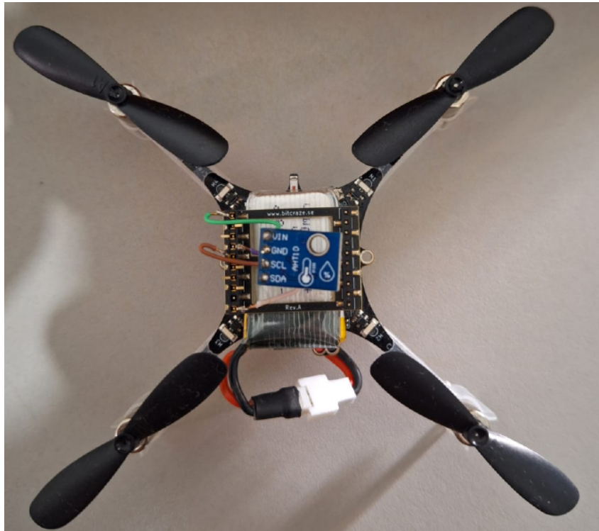
Figura 32 – Aeronave embarcada com o sensor AHT10 .
