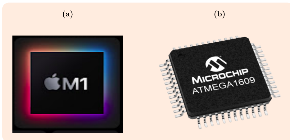
Figura 4 – Em (a) tem-se o microprocessador modelo Apple M1 . Em (b) tem-se o microcontrolador modelo ATmega1609 de 8 bits .
