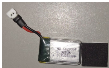
(b) Bateria de LiPo de 3,7 V (250 mAh).
