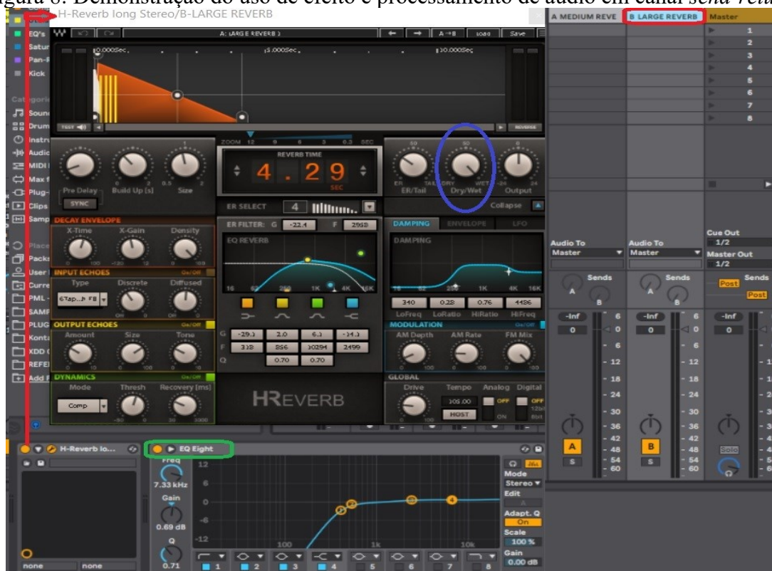
Figura 8: Demonstração do uso de efeito e processamento de áudio em canal send-return .
