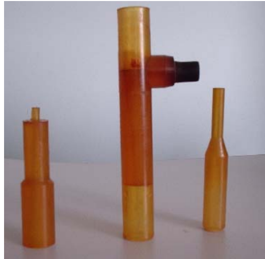
Figura 3.2 – Hidrociclone AKW com D_c = 10 mm.
