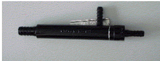
Figura 3.3 – Hidrociclone Krebs com D_c = \frac{1}{2} in.
