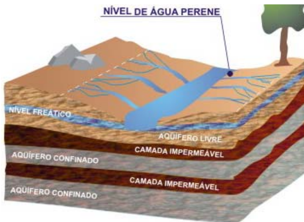
Figura 4 – Tipos de aquíferos quanto à pressão.
