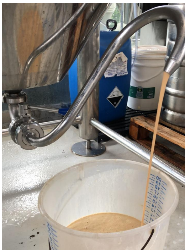
Figura 10: Sistema de extração do trub (válvula esfera, sifão e balde de 20L)
