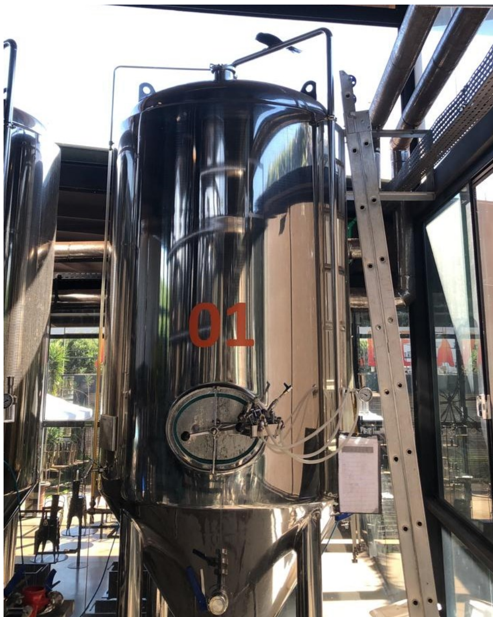
Figura 7: Tanque de 4000L de fermentação encamisado.
