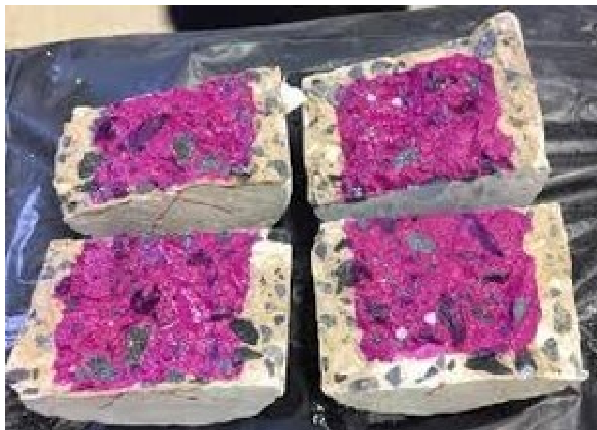
Figura 2 - Medição da camada carbonatada por aplicação de fenolftaleína
