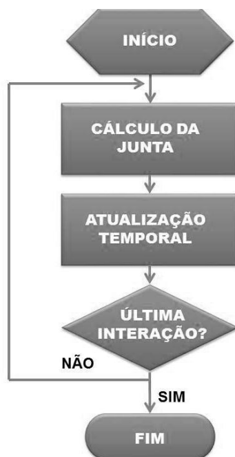
Figura 4.5 – Fluxograma do algoritmo básico da simulação da Malha de Guia Digital de Onda. Figura modificada de Van Duyne e Smith III (1993).
