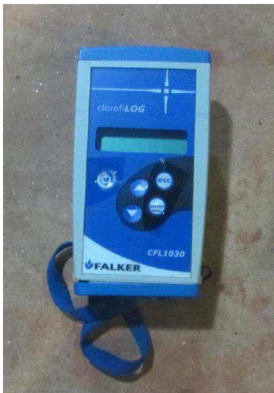
Figura 2. Aparelho Clorofilog utilizado na obtenção dos valores diretos de clorofila a e b.
