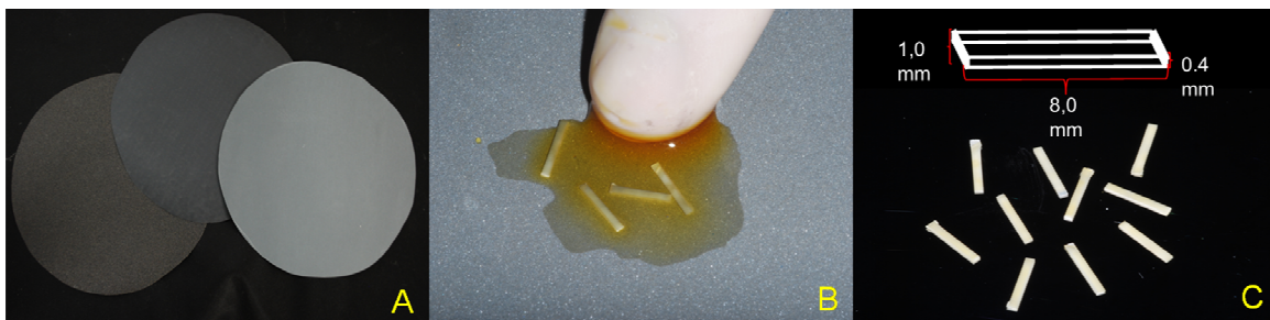
Figura 10. A – lixas de carbeto de silício com granulações 600, 1000 e 1200; B – refinamento manual das barras; C – barras acabadas.
