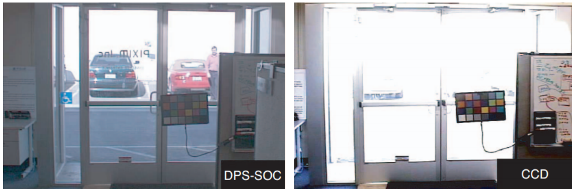
Figura 5 – Comparação de imagem de sensor CMOS e CCD: à esquerda, uma imagem de sensor DPS-SOC (CMOS); à direita, uma imagem de sensor CCD (GAMAL; ELTOUKHY, 2005)
