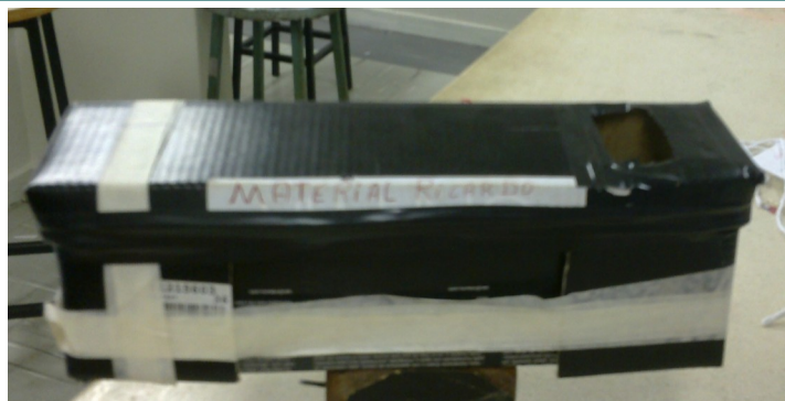
Figura 4: Espectrômetro feito com caixa de sapato e DVD.
