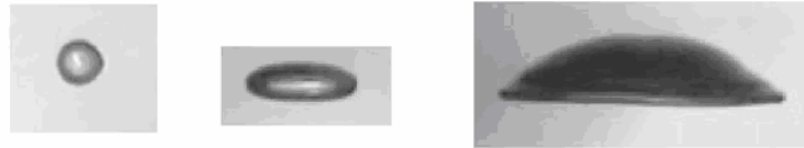
Figura 2.16 – Formato das bolhas encontradas nas soluções de CMC.
