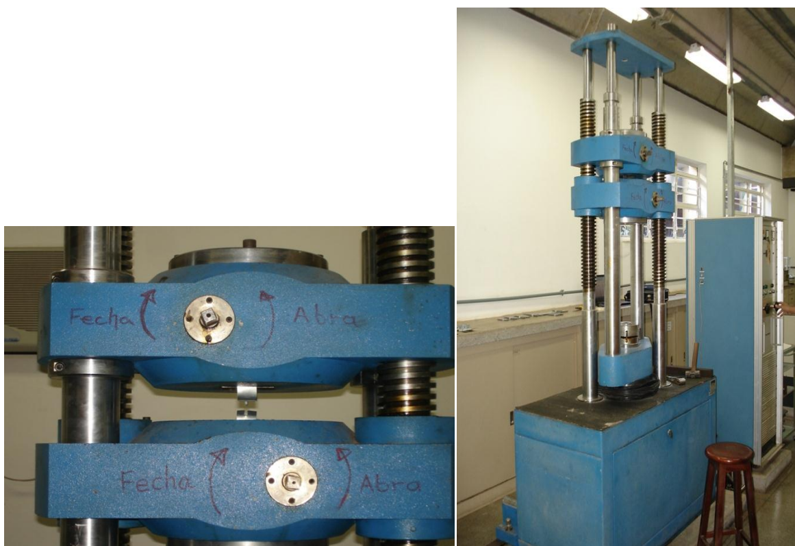
Figura 3.25 – Teste de arracamento utilizando máquina de tração
