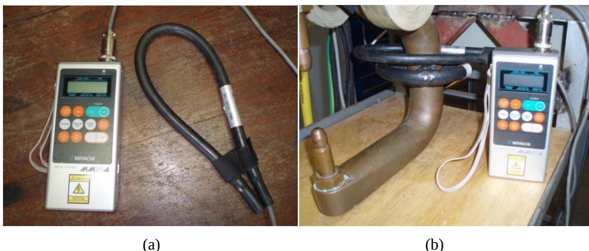
Figura 3.22 – (a) Analisador portátil Miyachi, (b) Posicionamento da bobina toroidal conjuntamente com o analisador
