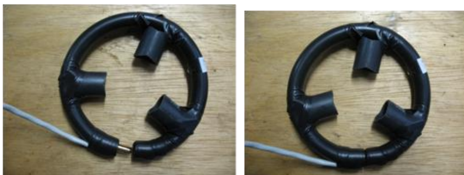
Figura 3.11 – Bobina de Rogowski rígida
