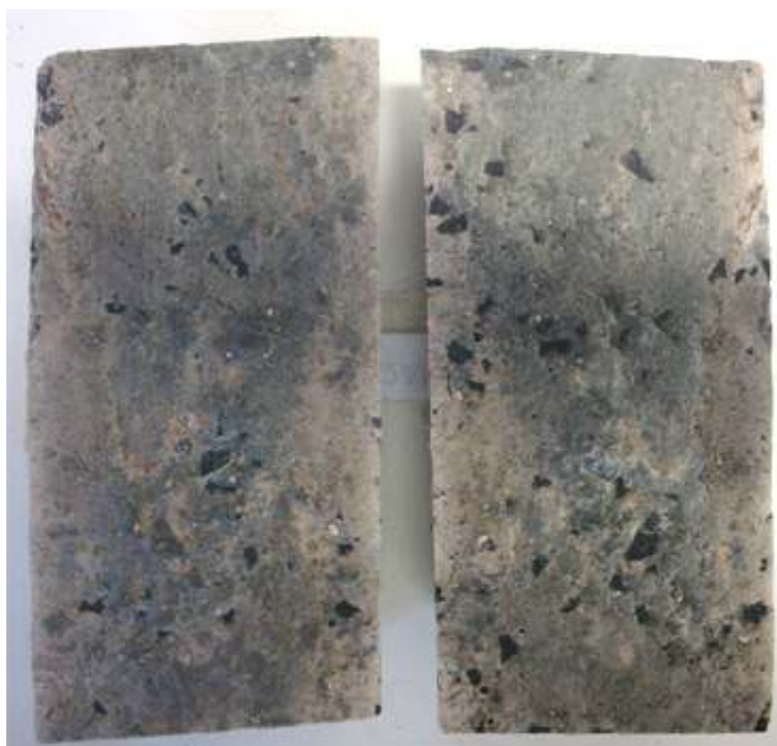
Figura 4.14 - Testemunho com junta horizontal entre concreto e substrato (C2AM-H)
