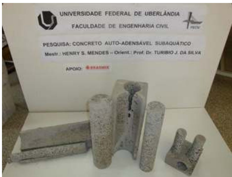
Figura 4.12 - Testemunhos e prisma de concreto
