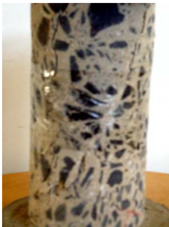
Figura 5.1 - Testemunho com substrato após o ensaio de compressão
