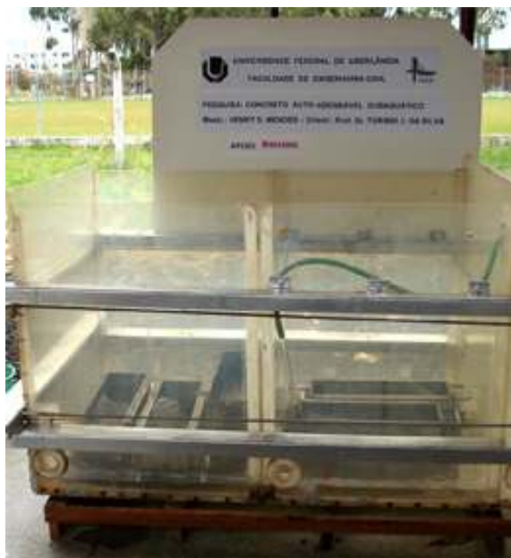
Figura 4.6 - Tanque em acrílico com os moldes posicionados para concretagem
