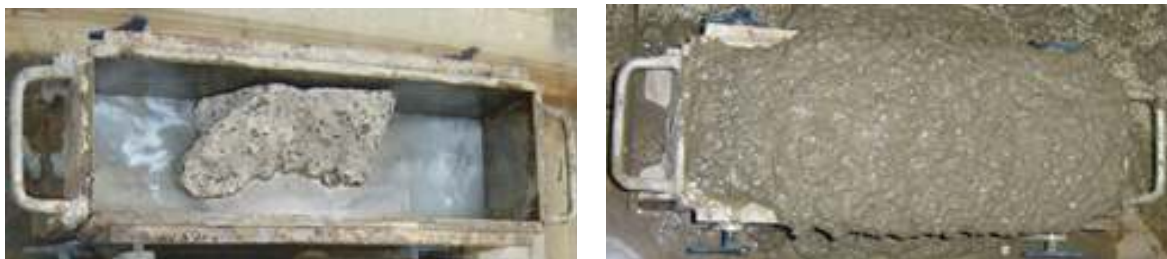
Figura 4.7 - Amostras de concreto antes da concretagem (esq.), após concretagem (dir.).
