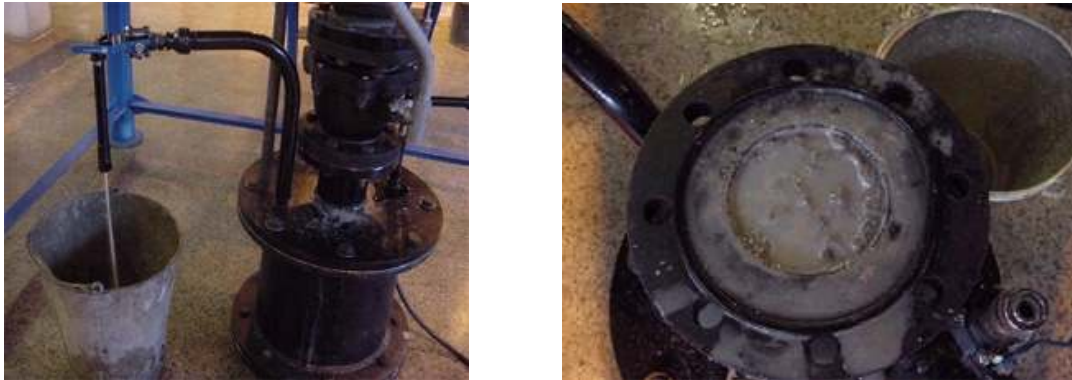
Figura 3.6 - Campânula inferior durante e após a simulação Água saindo pela válvula (esq.) e aspecto do concreto no final da concretagem (dir.) (fonte: GRAÇA et al., 2003b)
