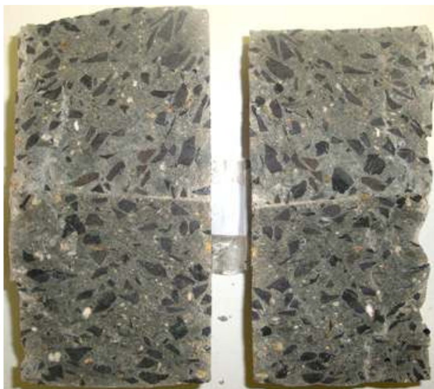
Figura 4.15 - Testemunho com junta horizontal entre concretos submersos (C1C2-H)
