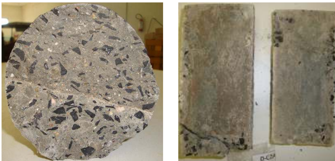
Figura 5.3 - Testemunho de concreto submerso com junta fora do plano de aplicação da força no ensaio de compressão diametral
