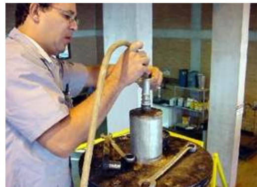
Figura 3.5 - Preparação da câmpula superior: O concreto à esquerda e a pressão à direita (fonte: GRAÇA et al., 2003b)
