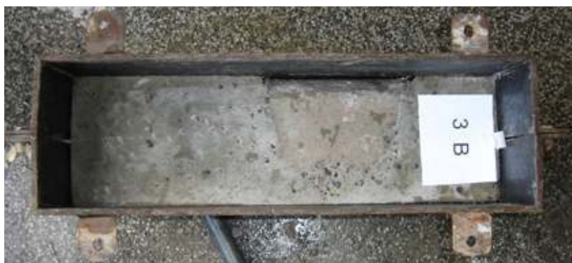
Figura 4.9 - Amostra de concreto preparada para concretagem da face lisa
