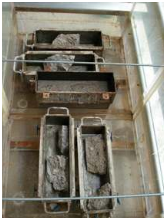
Figura 4.10 - Amostras do substrato preparadas para a segunda etapa de concretagem.
