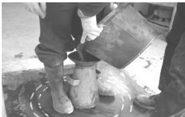
Figura 2.2 - Colocação do concreto no cone de Abrams (fonte: RAVINDRA et al. , 2004)
