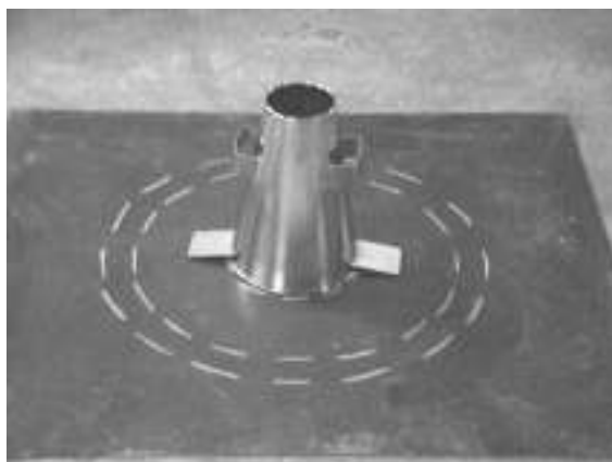
Figura 2.1 - Preparação para o ensaio de slump flow (fonte: RAVINDRA et al. , 2004)
