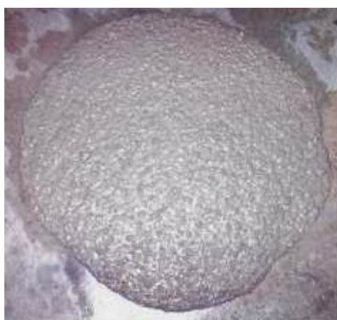
Figura 2.3 - CAA após o ensaio do slump flow (fonte: TUTIKIAN, 2004)
