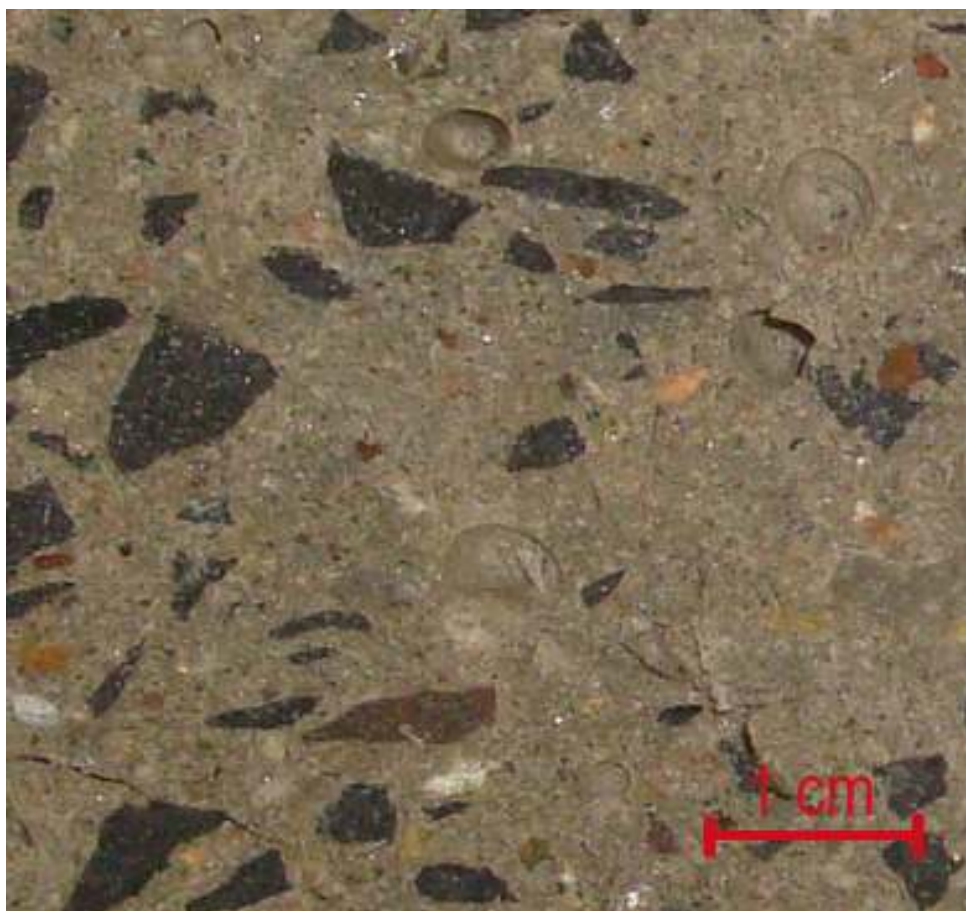
Figura 5.4 - Análise visual na seção de ruptura de um testemunho após o ensaio da tração por compressão diametral
