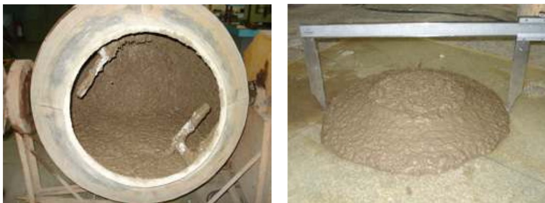
Figura 4.8 - Aspecto do concreto e slump flow
