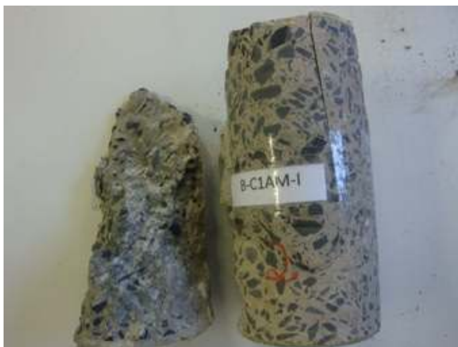
Figura 5.1 - Testemunho com substrato após o ensaio de compressão
