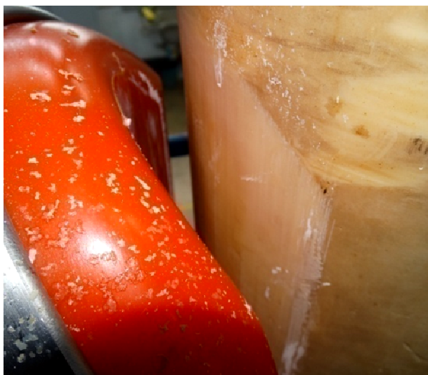
Figura 4.66 - Duto flexível na região em contato com a amostra de liner da esquerda, após 50.000 ciclos (3 km)
