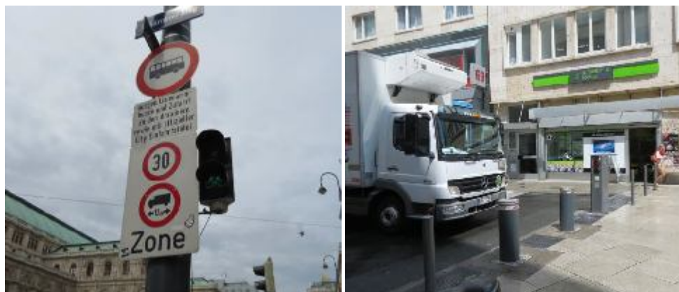
Foto montagem 03: Limite de acesso de veículos de carga em área comercial da cidade de Frankfurt/Alemanha, com a utilização de obstáculos físicos removíveis e placa de sinalização de acesso a zona com restrição de circulação de veículos de carga com mais de 12 metros de comprimento.
