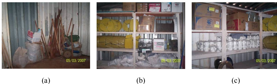
Figura 4.16 – Falta de identificação dos materiais guardados no almoxarifado – (a) ferramentas estocadas em um canto sem separação e identificação; (b) e (c) materiais estocados em prateleiras sem identificação.
